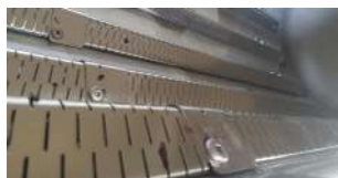
Elektropolírozott elvezető csatornák, szerszám nélkül gyorsan felszerelhető
