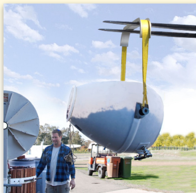
A nylon heveder névleges teherbírása 2800 kg, tehát egy teli tartály közel háromszorosa. Heveder hossza 335 cm Merevítő sín szélessége 1341 cm
